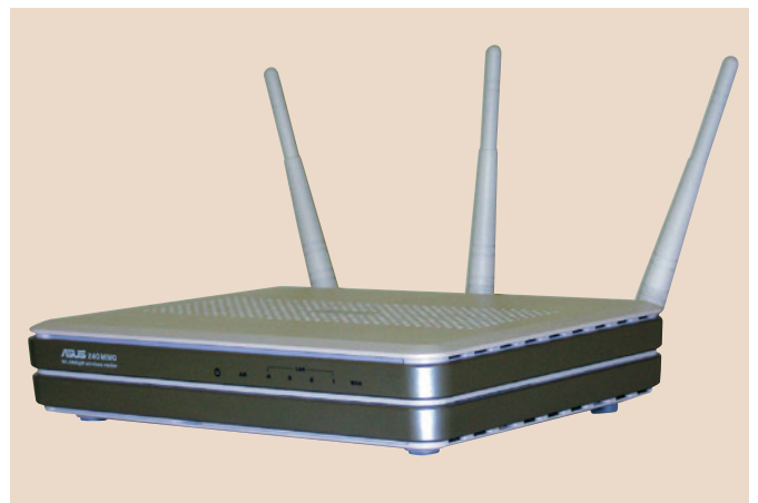
Маршрутизатор ASUS 240 MIMO Wireless Router WL-566gM на базе нестандартной технологии Airgo демонстрирует лучшие результаты по сравнению с первыми продуктами на основе Draft-N
